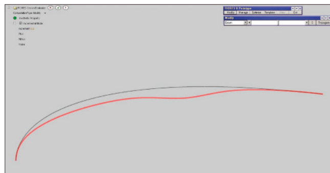
Bild 4: Acceleration beginnt immer in einem eher flachen Bereich und mündet in einen Bereich mit hoher Curvature, mit einem Radius. Eine zu träge Veränderung von Curvature zeigt überhaupt keine Acceleration.
